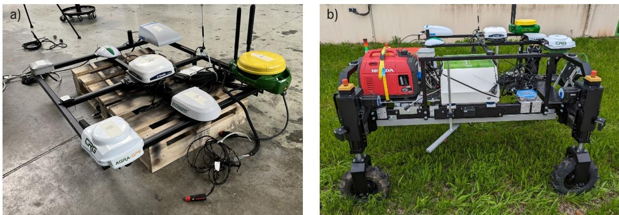
Abbildung 1: a) Trägerrahmen mit RTK-GNSS-Empfängern (© Lea Obermaier), b) Trägerrahmen auf Trägerfahrzeug Tipard 350 (© Magnus Hofmann)
