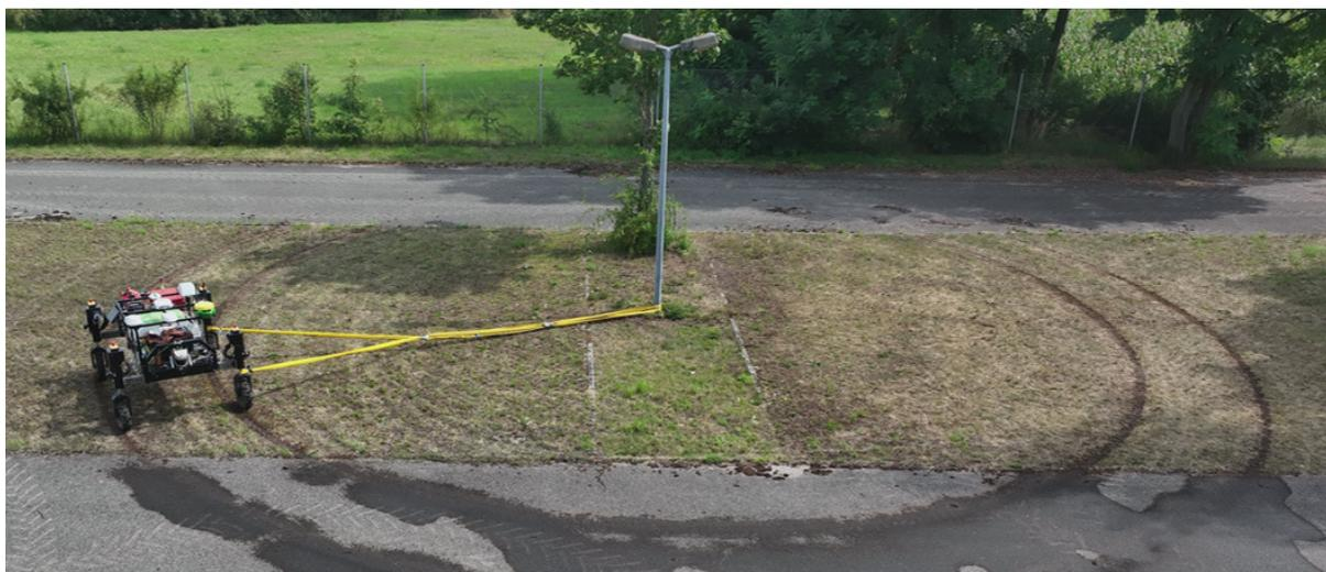
Abbildung 3: Testaufbau der Kurvenfahrt. Der Tipard der digital workbench GmbH wird über Schlupfe an einem Fixpunkt befestigt und damit auf einer fest definierten Kreisbahn gehalten; Fahrtrichtung auf dem Bild: im Uhrzeigersinn (© Kompetenzzentrum für Digitale Agrarwirtschaft (KoDA) der Hochschule Weihenstephan-Triesdorf)
