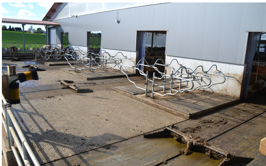
Abbildung 2: Strukturierter Laufhof des Untersuchungsbetriebes mit Entmistungsachsen und Wendeklappschiebern
