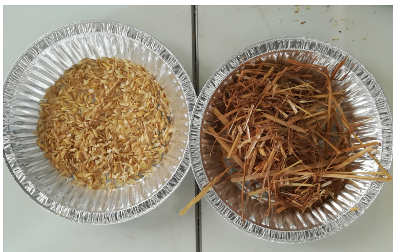
Abbildung 3: Einzelne Fraktionen des SpreuStroh-Gemisches; links Spreu, rechts Kurzstroh
