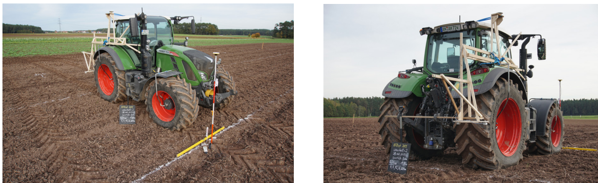
Abbildung 2: Messaufbau für die Erfassung der Referenzwerte der Spurtiefe und der Bodenfeuchte an einer Messstelle (links); Ultraschallsensoren und die Action-Kamera auf einem Gerüst hinter dem Traktor erfassen die Spurtiefe, die mit einem GNSS-Empfänger georeferenziert wurde (rechts) (© J. Poteko)
