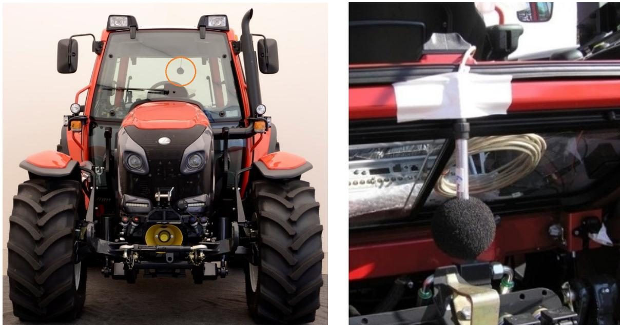
Abbildung 3: Mikrophonposition (Luftschall-Mikrophon Fahrer, Luftschall-Mikrophon Nahfeld Getriebe hinten) am Lintrac 90 (Foto: Lindner Traktorenwerk GmbH)
