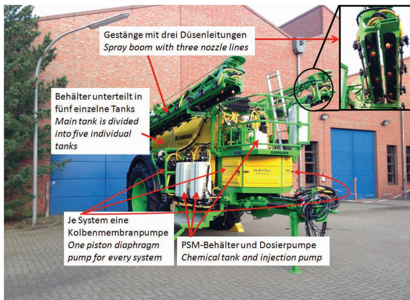
Abbildung 2: Feldspritzgeräteprototyp mit Direkteinspeisung (Foto: M. Krebs)
