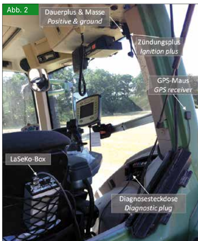
Installierte LaSeKo-Box mit Steckdosen auf Traktor (Foto: C. v. Toll) Fig. 2: Installed LaSeKo-Box on tractor with plugs
