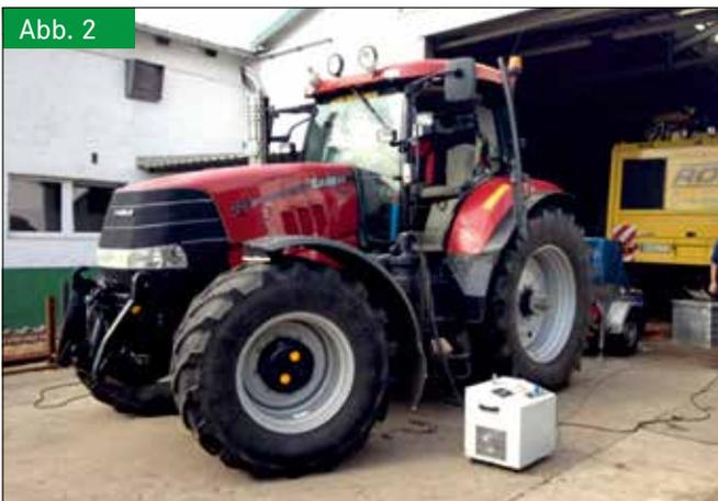
Case CVX 225 Puma während der Leistungsmessung an der Zapfwellenbremse (Foto: Trefflich)
