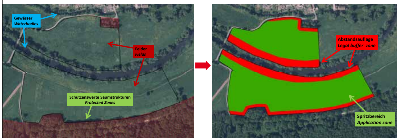
Funktionsweise des Abstandstools Fig. 3: Functionality of the buffer zone tool
