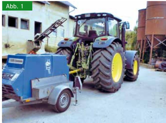
Prüfstandsmessung – Wirbelstrombremse „Eggers Dynamometer“ an der Zapfwelle
