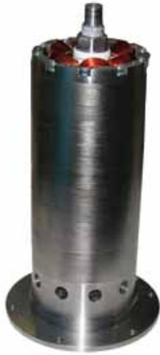
Elektromotor mit Befestigungsflansch (Foto: TU Wien) Fig. 1: Electric drive with flange
