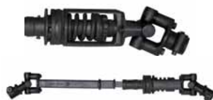
Original IHC – Gelenkwelle mit Stirnratsche, Baujahr ca. 1950 Fig. 5: Original IHC PTO drive shaft with axial ratchet clutch, ca. 1950
