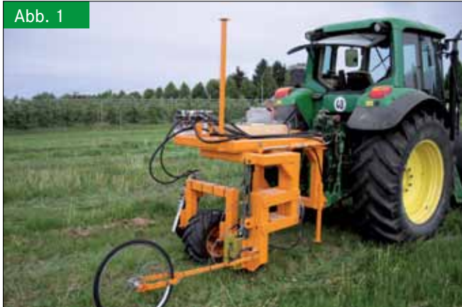
Mobile Einzelradmesseinrichtung bei Messfahrt mit AS-Profilrad (Foto: Morhard) Fig. 1: Test rig for single wheels on test run with small tractor tire
