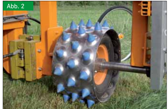
Stachelwalze in mobiler Einzelradmesseinrichtung auf Grasstoppel (Foto: Morhard) Fig. 2: Studded roller-wheel in test rig for single wheels on grass stubble
