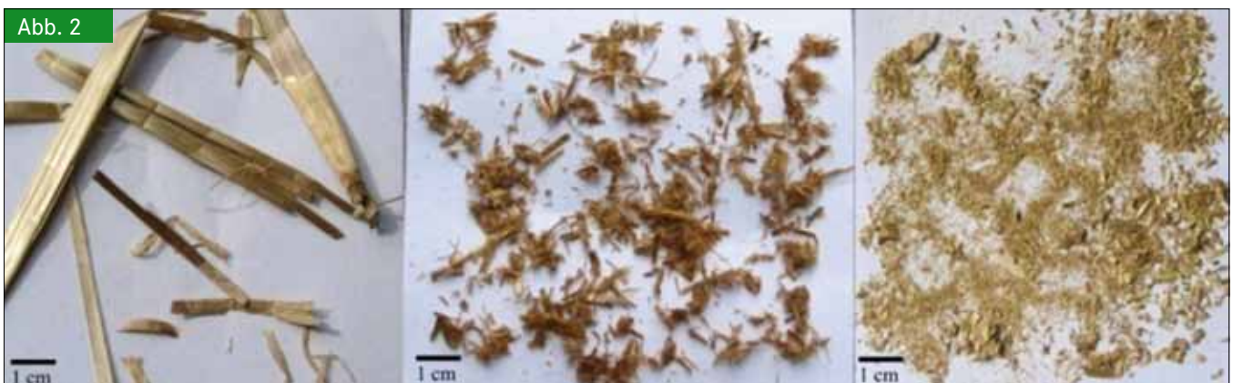
Unbehandeltes (links), nass extrudiertes (Mitte) und trocken extrudiertes Stroh (rechts) Fig. 2: Untreated (left), wet extruded (middle), and dry extruded straw (right)
