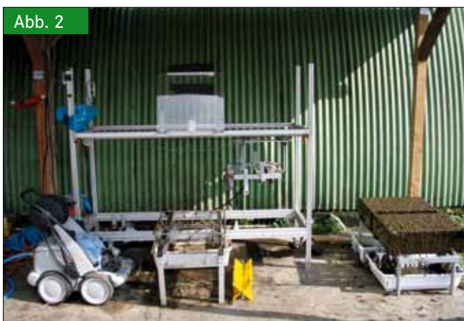
Versuchsstand mit dem Gummischieber, den anbaubaren Räumsternen und der Hochdruckreinigung sowie ein Abtropfgestell für die künstliche Reinigung (Foto: Retz) Fig. 2: Test stand with rubber scraper, extractable star rotors, high pressure cleaner and dripping frame for artificial soiling
