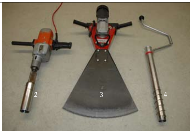
In der Untersuchung verwendete Probenehmer: 1 – Siloblockschneider; 2 – Kernlochbohrer (ART); 3 – Elektrischer Silageschneider; 4 – Pioneer™-Bohrer
