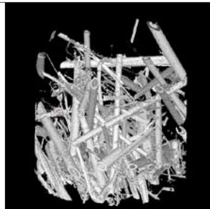
Freigeschnittene Strohprobe und die zugehörige CT-Aufnahme der Probe (Foto: Kattenstroth)
