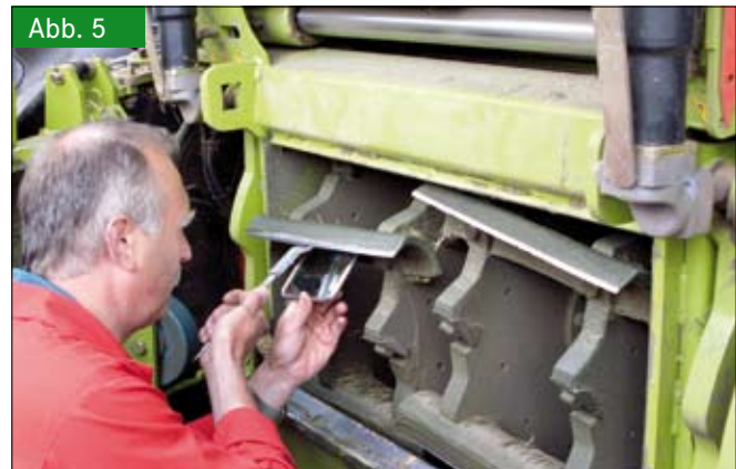
Kontrolle des Feldhäckslers-Messers durch den Fahrer (Foto: HTW Dresden)
