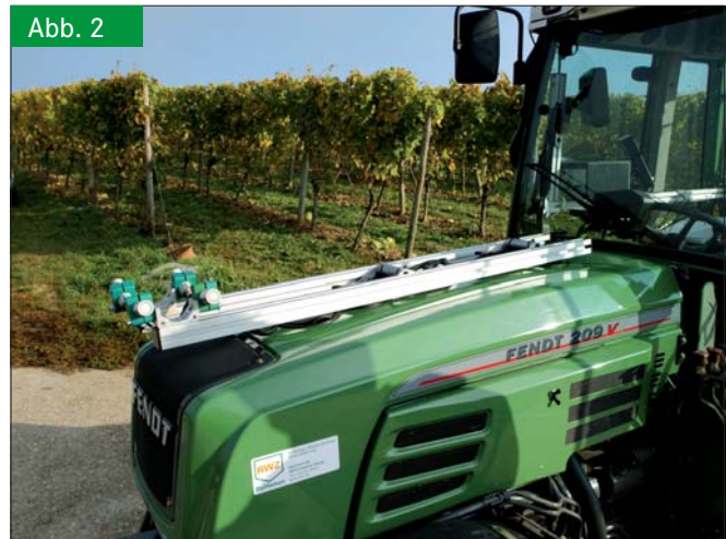
Versuchsschlepper mit Ultraschallsensorik Fig. 2: Experimental tractor with mounted ultrasonic sensors
