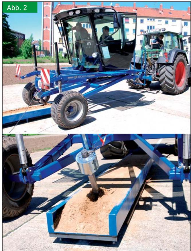
Mobiler Versuchsträger mit Ultraschallzinken und Bodenrinne.
