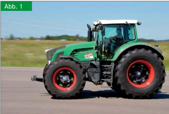
Fendt Vario 936 Versuchsmaschine mit Kistler-Messfelgen. Foto: Universität Hohenheim Fig. 1: Fendt Vario 936 test machine with Kistler measuring rims
