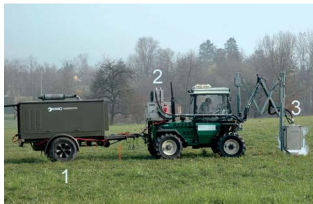
Selbstfahrender Mikrowellenprototyp. 1 = Stromgenerator, 2 = Hochspannungseinheit mit Kühlung, 3 = hydraulisch positionierbarer Kopf mit Magnetrons und Hohlleiterausgängen. Foto: ART
