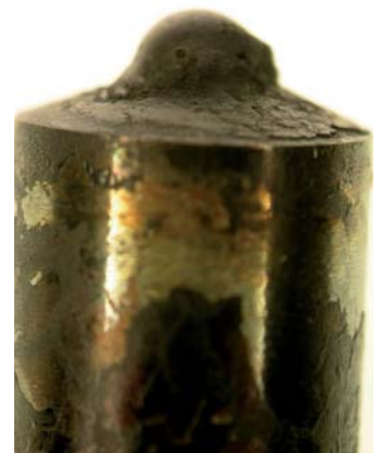
Ablagerungen an Einspritzdüse von Zylinder 1 des Fendt Vario 412 nach 2653 Bh Fig. 2: Deposits on the injection nozzle of cylinder 1 of the Fendt Vario 412 after 2653 operating hours
