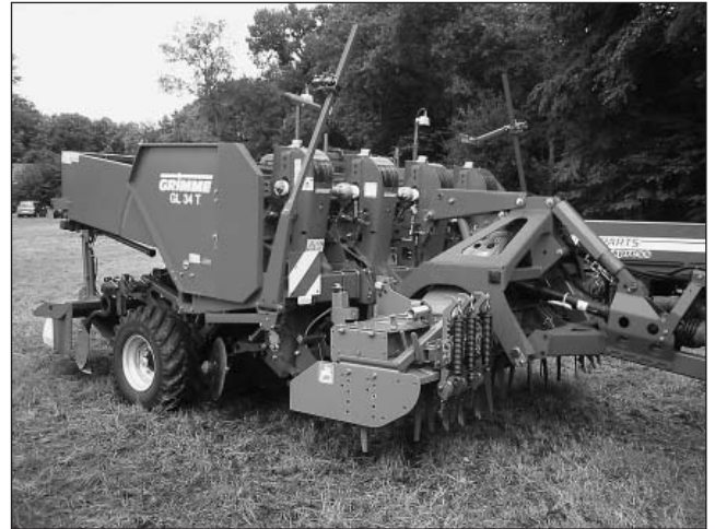
Bild1: Mit der GL 34 T von Grimme lassen sich Bodenbearbeitung, Legen von Kartoffeln und Dammaufbau in einem Arbeitsgang durchführen (Foto Dr. Metzner)
