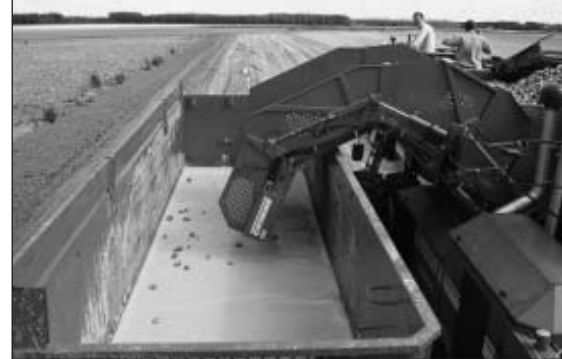
Bild 3: Beim neuen Varitron 270 von Grimme wurde auf eine schonende Übergabe des Erntegutes großer Wert gelegt (Werkbild)
