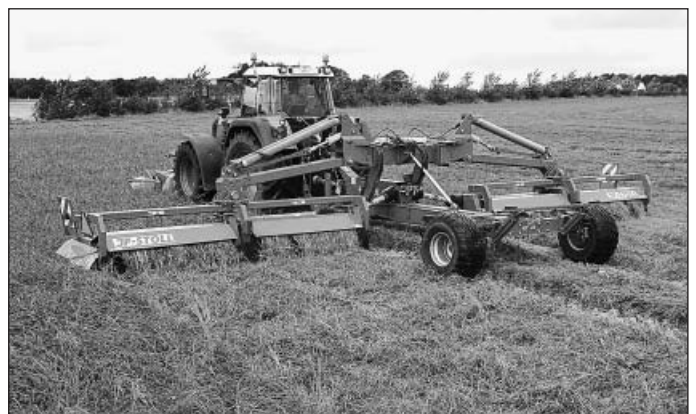
Bild 1: Zur Agritechnica stellt Stoll seine GXT Triple-Mähwerkskombination mit Arbeitsbreiten von 11,6 m oder 14,6 m vor (Werkbild)
