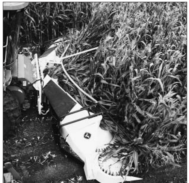
Bild 3: Für die Ernte von massenstarkem Energie-Mais entwickelte Kemper seinen reihenunabhängigen Häckslervorsatz Champion 475 (Werkbild)
