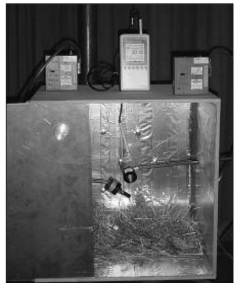
Bild 1: Staubfreisetzungswürfel mit PGP-GSP und -FSP Sammelköpfen sowie dem Ahlborn Klimamessgerät
