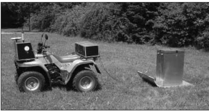
Bild 2: ATV mit RTK-GPS und Kamera-Trägerchassis zur Erfassung der Bodenbedeckung durch Stroh
