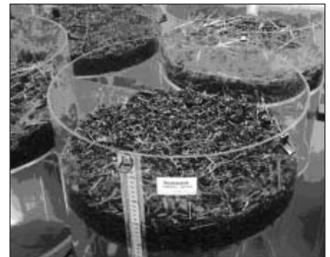
Bild 1: Versuchsbehälter mit Weizenstrohkurz-häcksel-Legehennenkot-Gemisch
