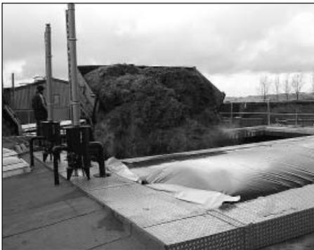
Bild 3: Befüllung des Zwei-Ebenen-Fermenters
