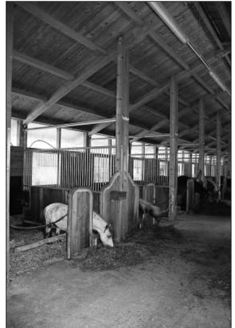
*Bild 6: Spezielle Frontabtrennungen mit Fress-schlitzten und herausziehbare Zwischenabtrennungen bringen der Familie Staud erhebliche arbeitswirtschaftliche Vorteile in ihrem Pferdestall.*
