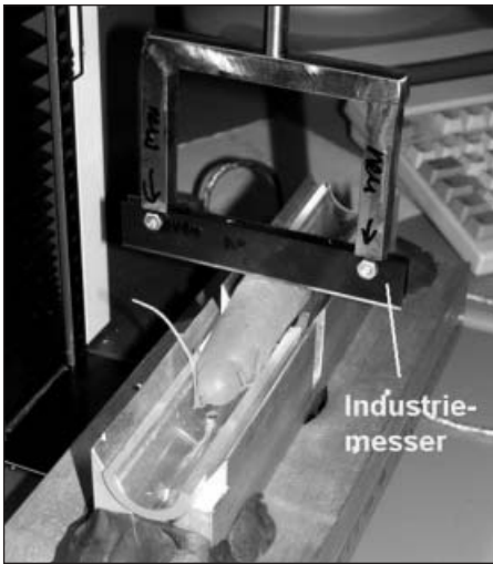
Bild 2: Anordnung zum Schneiden der Möhre mit Industriemesser unter Verwendung einer Universalprüfmaschine
