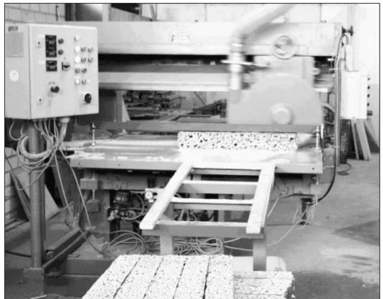
*Bild 3: Schneiden der Kernstoffblöcke mit einer Plattenkappsäge*
