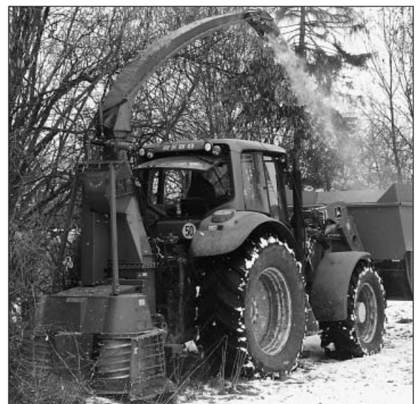
Bild 1: Erster Prototyp des Göttinger Gehölzmähhäckslers „Tritucap“ mit Überladeeinrichtung
