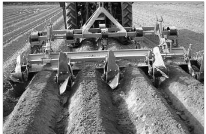
Bild 2: Gerät zum Anlegen von Querdämmen in Kartoffelfurchen zur besseren Wasserspeicherung
