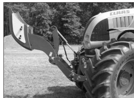
Bild 3: Eine pfiffige Lösung ist das variable Frontgewicht - hier am Ares - , das Claas auch für fremde Traktormodelle zur Verfügung stellt.
