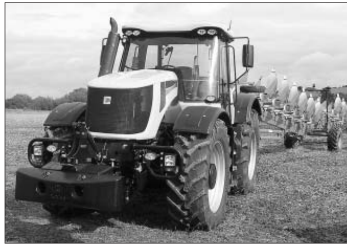
Bild 4: Zu neuen Ufern will JCB mit seinem 185 kW starken Fastrac 8250, der 65 km/h schnell ist und über ein modifiziertes Vario-Getriebe verfügt.
