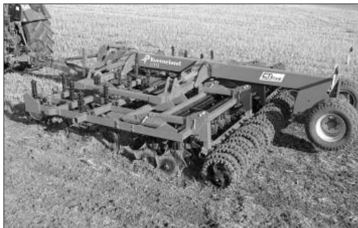
Bild 2: Je nach gewählten Grubberscharen soll der CTO von Kverneland für die Bodenbearbeitung von 5 bis 25 cm geeignet sein. Zwei Reihen Rotorsterne dienen Krümelung und Rückverfestigung.
