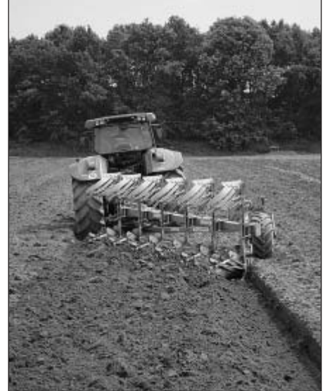
Bild1: Beim VariTansanit wird über die Steuerung des hydraulischen Oberlenkers die Hinterachse zusätzlich belastet
