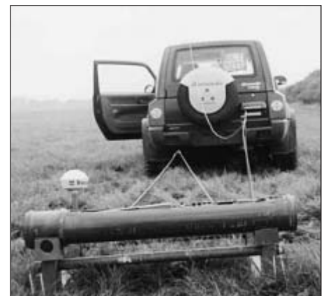
Bild 2: Messgerät EM38 und Transportfahrzeug zur Messung der Bodenheterogenität
