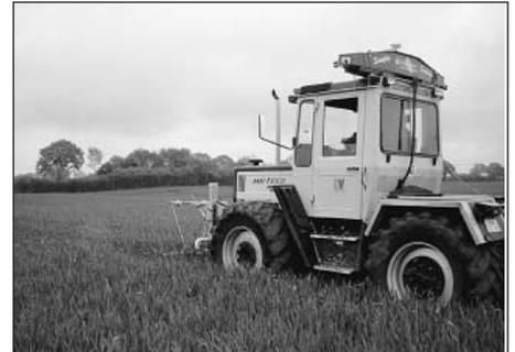
Bild 1: Pendel-Sensor und N-Sensor am Traktor montiert
