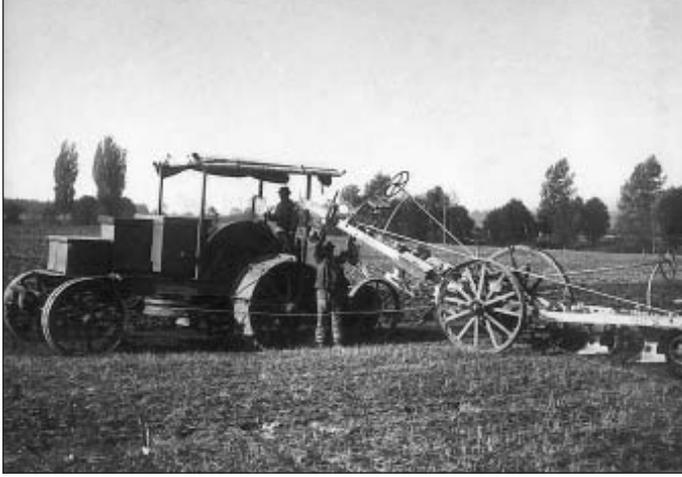
Bild 2: Elektropflug auf der Basis des Siemens'schen Patents von 1880
