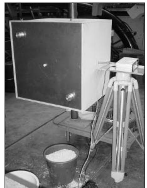
Bild 1: Rotierender Würfel zur Staubmessung
