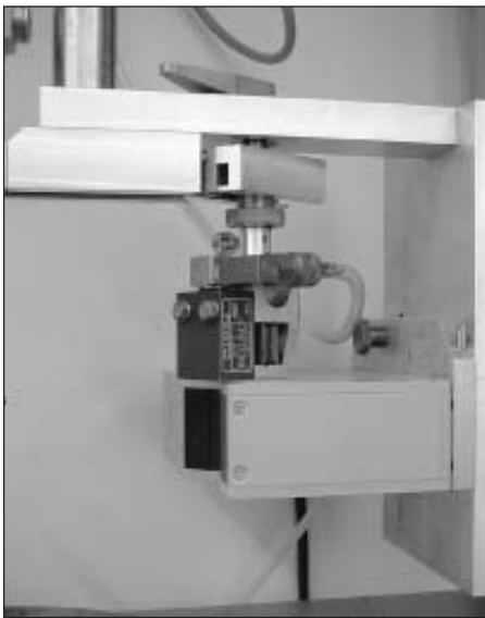
Bild 2: Laserdiameter zur Querschnittsmessung der Faserbündel
