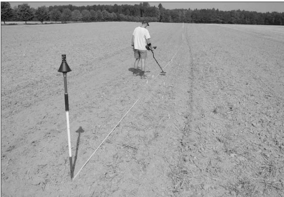
Bild 2: Bestimmung der Einarbeitungstiefe der Messkörper mit dem Metalldetektor
