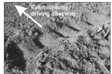
Bild 1: Bestimmung der Arbeitstiefe durch Freilegen des Bearbeitungsgrundes
