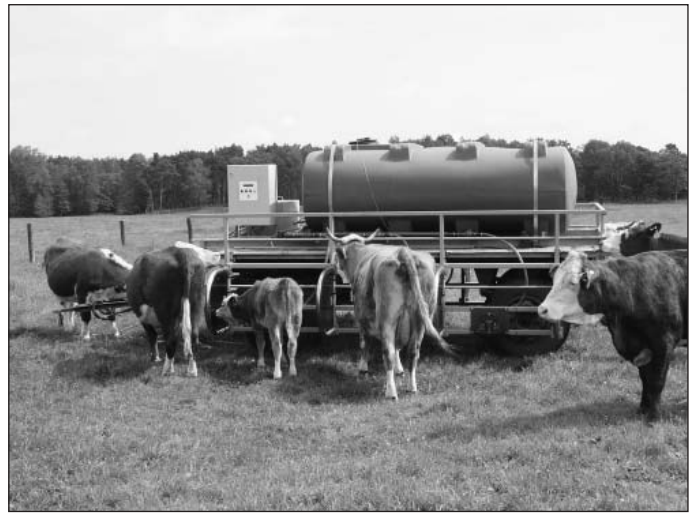
Bild 1: Tränkwagen zur Erfassung der individuellen Wasseraufnahme
