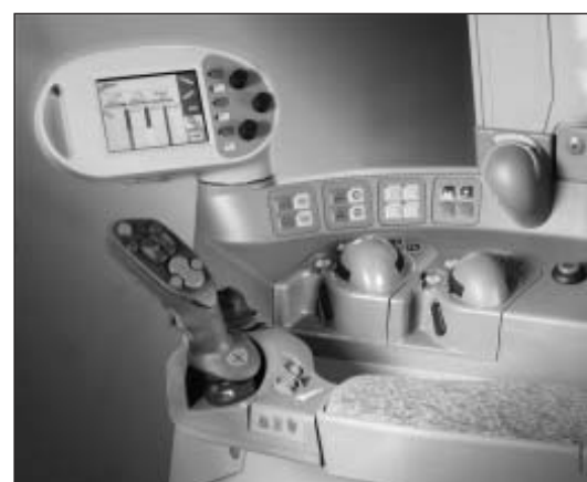
Bild 1: Fahrerplatz eines Traktors mit Multifunktionsfahrhebel in der Armlehne, Terminal und Tastern für eine „Finger - Tip“ Bedienung bei Fendt Traktoren [Werkbild]
