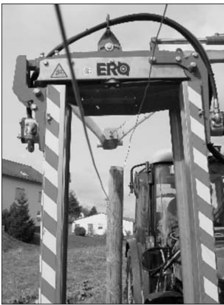
Bild 2: Laubschneider, am stromdurchflossenen Draht des Unterstützungsgestütes gesteuert (Foto: ERO)
