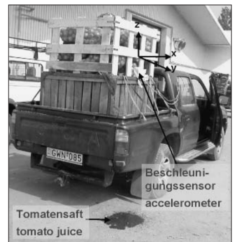
Bild 1: Kleintransporter mit Container, zur Hälfte mit Tomaten und darüber mit Zwiebeln (16 Säcke je 25 kg) befüllt, um die Ladehöhe des Lastwagens zu simulieren
