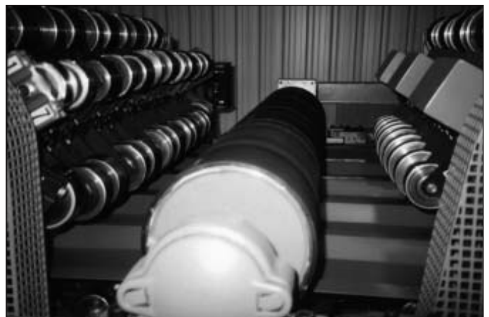
Bild 1: Produktionsmaschine für Trapezblech (Quelle: Firma Laukien, Kiel)
