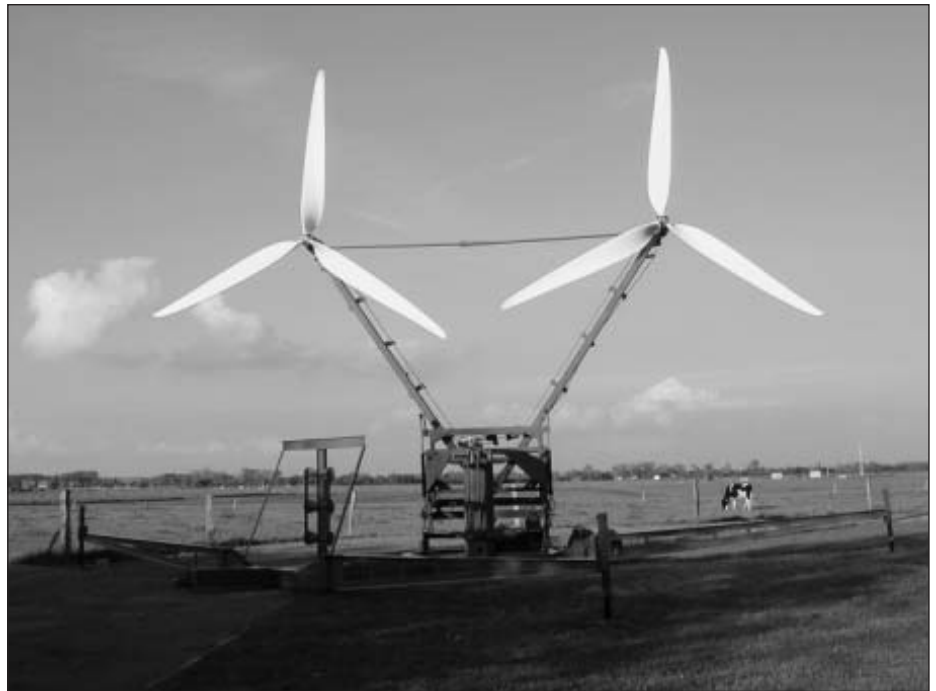
Bild 2: Aufgebaute mobile Windkraftanlage MoWEC
