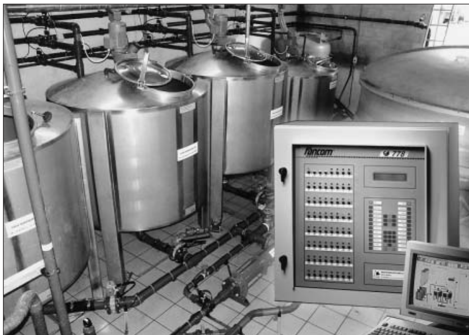
Bild 2: Der Flüssigfütterungscomputer 778 von Fancom steuert automatisch auch komplexe Futterküchen in Großbetrieben
